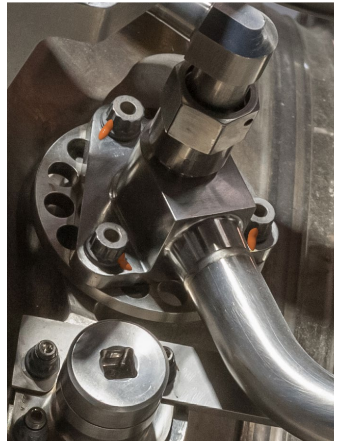
Gesicherte Schrauben an einem Flugzeug
