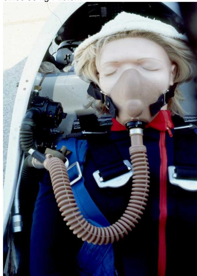
"Diluter demand"-Anlage mit bulkigem, rein mechanisch höhengeregeltem O<sub>2</sub>/air-Mixer und dem lästigem Faltschlauch. Würde ab 7'600 m 100 % O<sub>2</sub> eingeatmet, so verlassen noch 95 % O<sub>2</sub> das System mit jeder Ausatmung.
