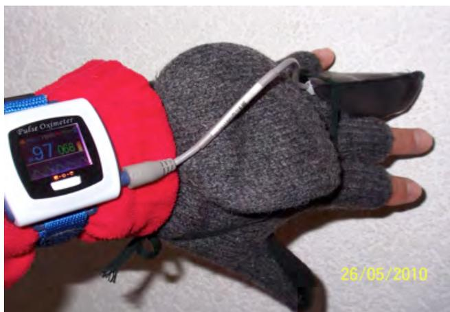
Handgelenks-Pulsoxymeter CMS-50F mit interessanter Speicher und Alarmfunktion. Der Lederfingerling schützt den O<sub>2</sub>-Sensor gegen Sonnenlicht-Einfall. **Achtung**, dieses ist noch kein "must have gadget" für Alpensegelflieger, da sein Farbbildschirm mit der Sonnenbrille weder im Sonnenlicht noch im Handschatten ablesbar ist und auch das "alarm silencing" eine unlesbare Menüfunktion ist!
